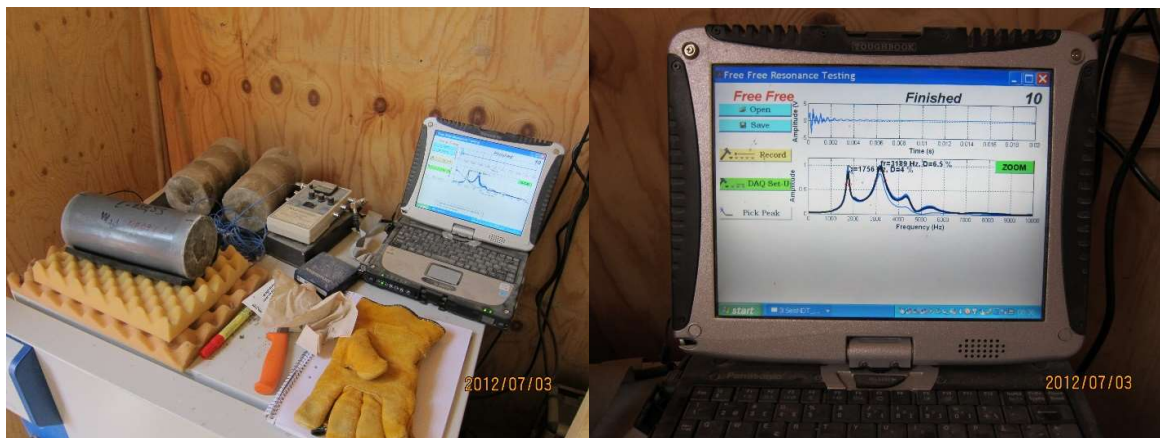
Figur 3 Exempel på försökupställning seismisk mätmetod (Foto: B.R. Nilsson)
