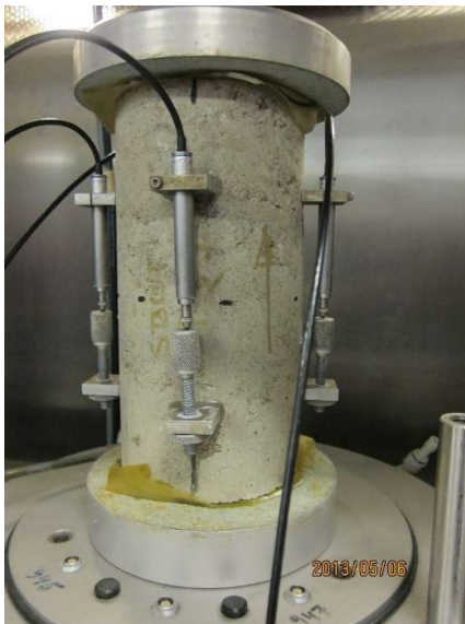
Figur 2 Exempel på enaxiell försöksupställning (Foto: B.R Nilsson)
